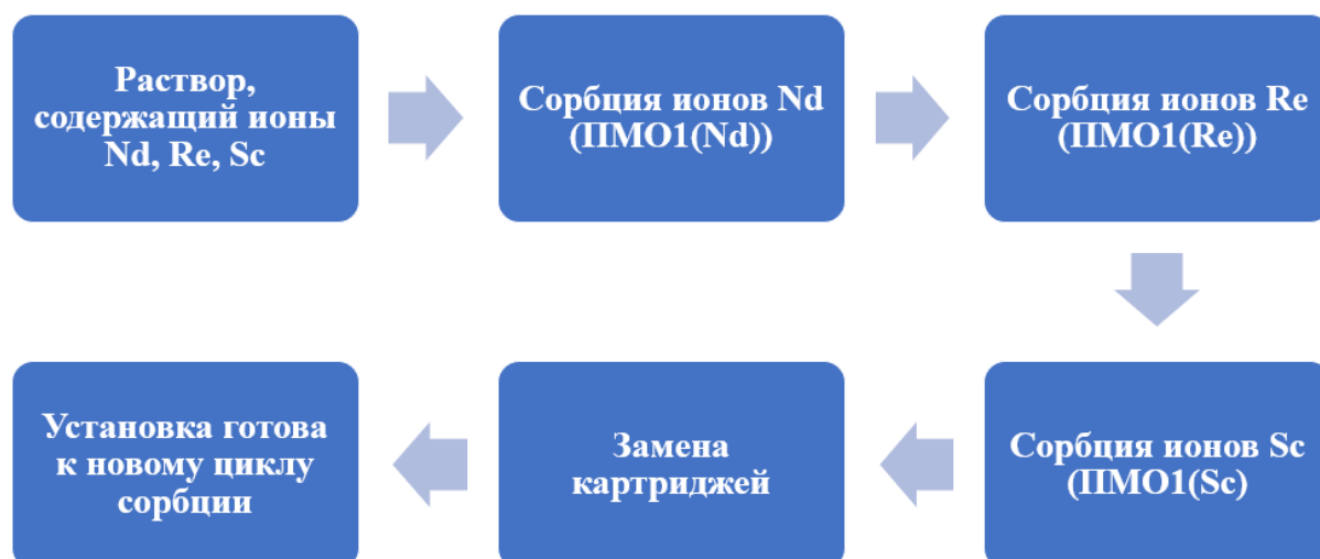
Рисунок 4. Схема извлечения ионов Nd, Re, Sc структурами ПМО1(Nd), ПМО1(Re), ПМО1(Sc)
