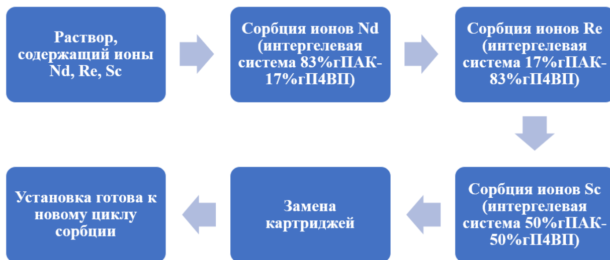
Рисунок 3. Схема извлечения ионов Nd, Re, Sc интергелевой системой гПАК-гП4ВП
