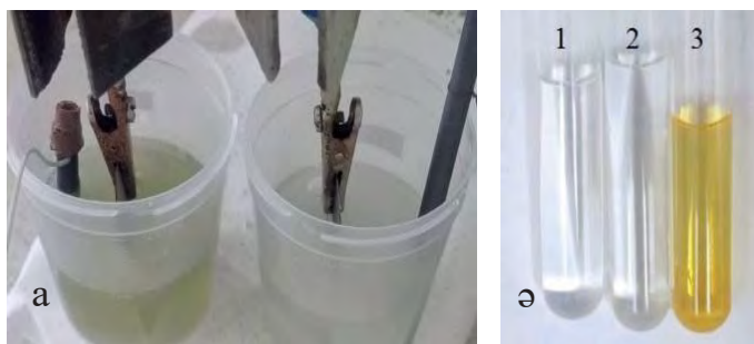
Сурет 2 – Электролиз процесі (а) және анодтық кеңістікте түзілген ерітіндінің құрамына жасалған сапалық анализ нәтижесі (ә): 1) титан (II) ионы жоқ; 2) титан (III) ионы жоқ; 3) титан (IV) ионы бар (сары ерітінді)
